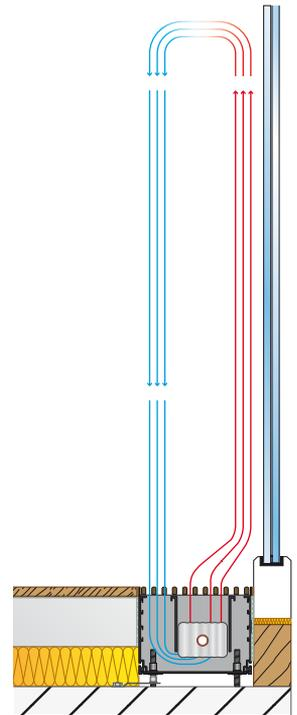
**Einzigartig:** Variotherm Bodenkanalheizungen haben das Heizelement direkt bei der Glasfläche. Dadurch wird binnen kürzester Zeit ein Warmluftschleier entlang der kalten Flächen aufgebaut und deren Kälteeinwirkung abgeschirmt.
